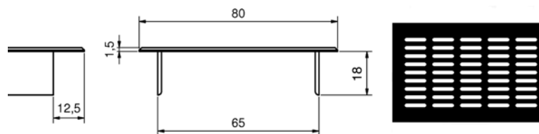
Grille d'aération en aluminium avec hauteur 80 mm - petits trous ovales: 20 x 3 mm
